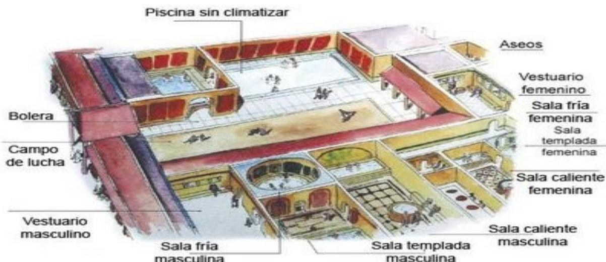
Para la temperatura del agua se utilizaban cámaras subterráneas donde, en hornos con ladrillos refractarios -*prae-furnium*-, calentaban el agua que, posteriormente, pasaba por canalizaciones debajo de las estancias hasta su piscina final. La pavimentación era en *opus signinum*, esto es ladrillo con argamasa, para facilitar la transmisión del calor y convertirlo en suelo radiante.
